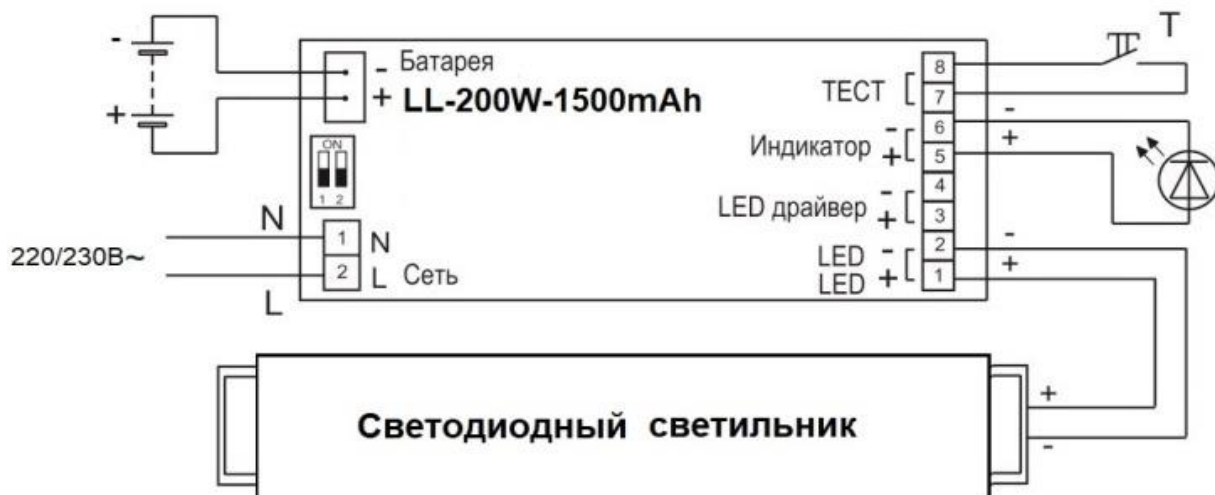
Схема подключения блока аварийного питания в непостоянном режиме
